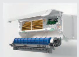
Abrir las pestañas traseras y sacar todo el tren de ventilación, incluyendo la bandeja de condensados
